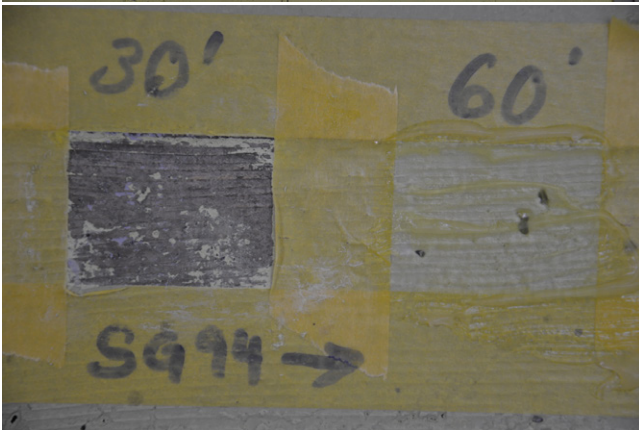
Resultat SG 94 nach 30' Einwirkzeit: beinahe vollständige Lösung der Übermalung.
